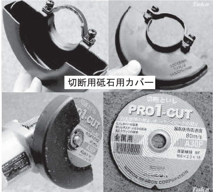
切断砥石用のカバー（両面が180°カバーで覆われている）
